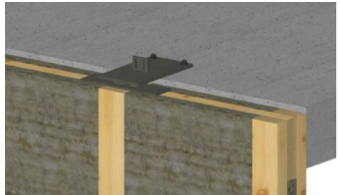
**Figure 19 - Fixation définitive du plat de liaison par goujons d'ancrage**
