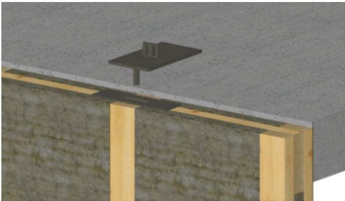
**Figure 18 - Insertion du plat de liaison dans l'étrier de panneau**
