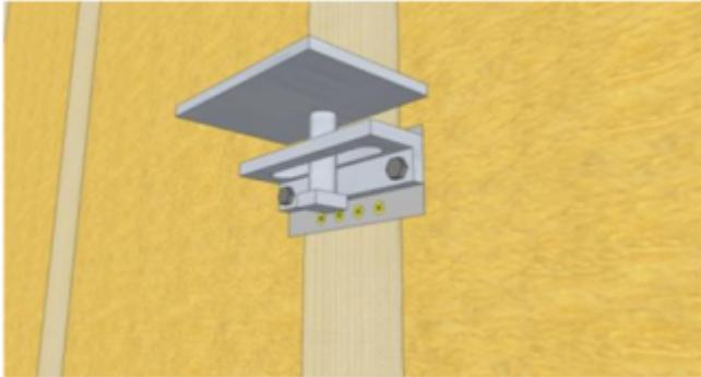
**Figure 24 - Insertion du plat intermédiaire et verrouillage par 1/4 de tour**
